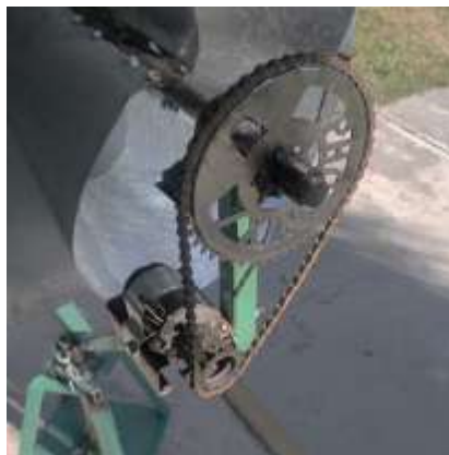
Figura 6. Ensamble del sistema de engranes de estrella para la transmisión de movimiento del aerogenerador. Fuente: (Elaboración propia).
