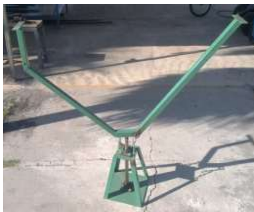
Figura 4. Unión de las partes metálicas de la estructura del prototipo con base a su diseño en SolidWorks. Fuente: (Elaboración propia).
