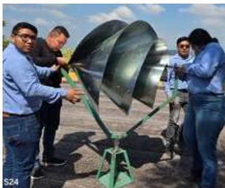
Figura 8. Colocación del aerogenerador en la azotea del edificio institucional para pruebas de funcionamiento en condiciones reales. Fuente: (Elaboración propia).
