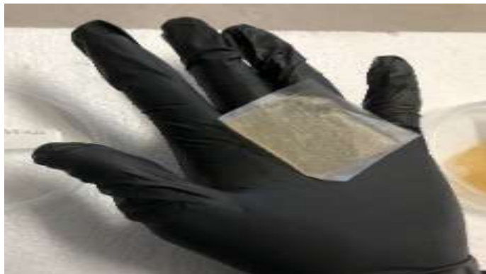
Figura 2. Parches de hidrogel pectina-quitosano
