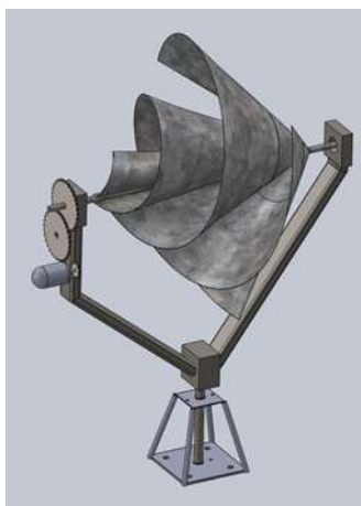
Figura 2. Diseño de prototipo de aerogenerador de Arquímedes. Fuentes (Elaboración propia)
