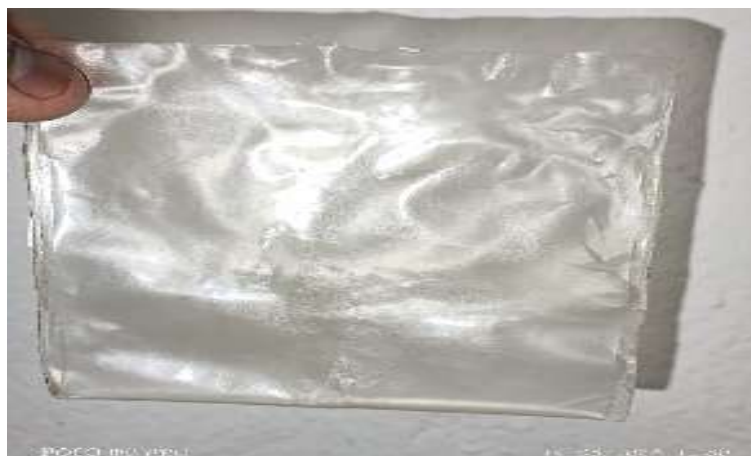
FIGURA3. .Bioplástico de almidón funcionalizado con NpsAg.
