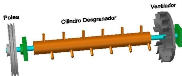
Figura 2. Imagen componentes de desgranadora de maíz
