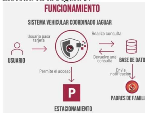
Figura 3. Funcionamiento del sistema completo
