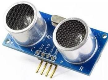
Figura 4. Imagen Sensor ultrasónico
